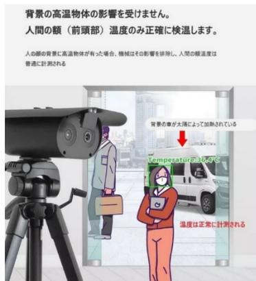
背景に高温物体がある場合にはサーモカメラが背景の赤外線の影響を受け計測対象の正確な温度計測が不可能となります。
